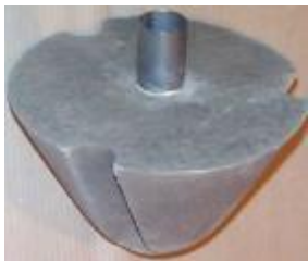
Slag Dart Refractories
